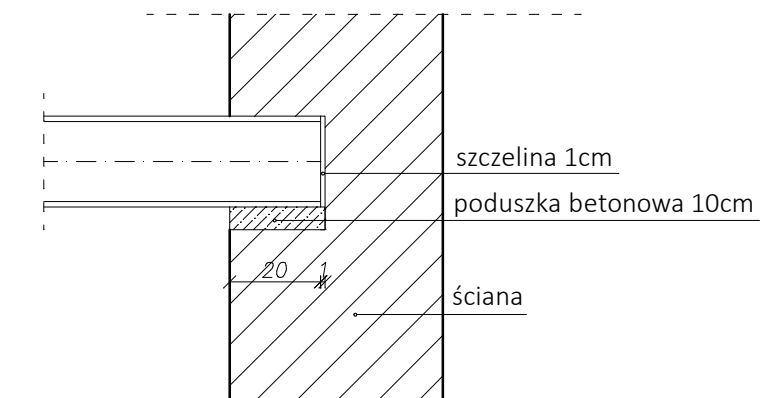
Szczegół oparcia belki stalowej na ścianie
